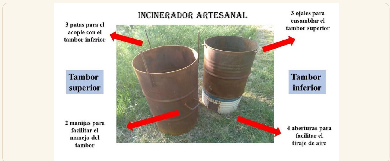
Incinerador artesanal: tambor superior e inferior con tiraje de aire.
